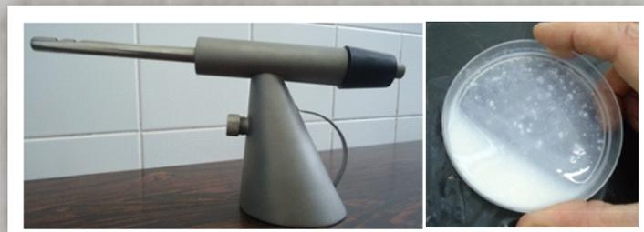
Figura 1: Pistola de álcool utilizada pelo transportador e resultado positivo ao teste indicando leite instável (com grumos).
